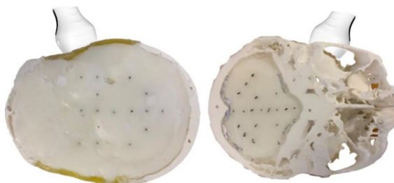
Рисунок 4 – Расположение датчика с фазированной решеткой относительно фантома головы
