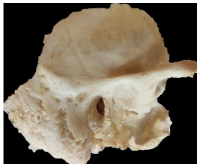
Рисунок 3 – Изображение ex vivo височной кости, используемой в качестве аббератора
