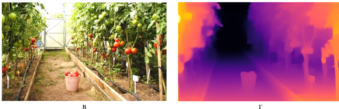
Рисунок 2 – Определение расстояния до кустов с применением DepthAnything: а), в) исходные изображения; б), г) изображения, обработанные DepthAnything
