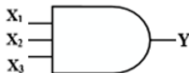
Рисунок 2 – Графическое изображение конъюнкции с тремя входами в цифровой схеме
