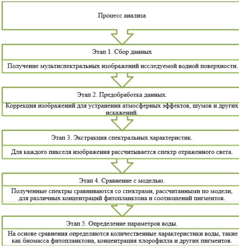
Рисунок 1 – Процесс анализа спектральных характеристик водных сред
