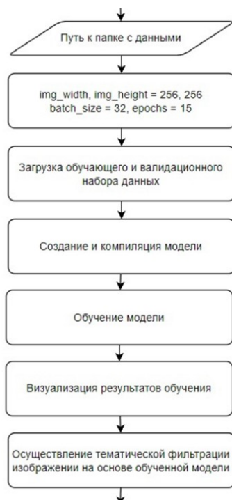
Рисунок 11 – Алгоритм фильтрации изображений графиков зависимостей
