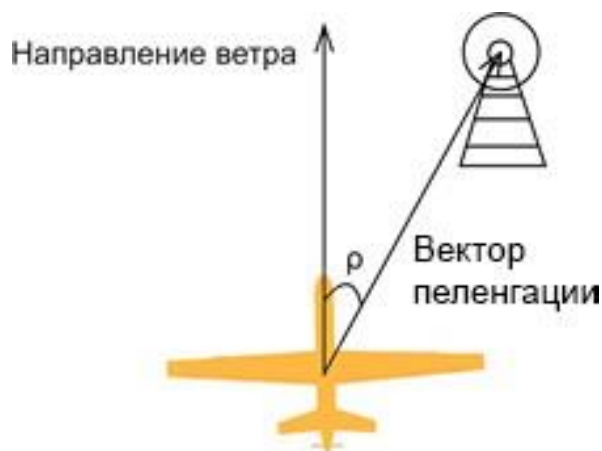
Рисунок 6 – Угол между вектором пеленгации и направлением ветра
