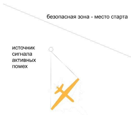
Рисунок 3 – Схема нахождения БПЛА в зоне работы активных помех
