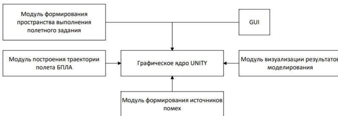
Рисунок 8 – Схема комплекса программных модулей моделирования безопасной полетной траектории БПЛА
