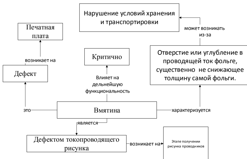
Рисунок 2 – Фрагмент семантической модели представления знаний о возникающих на различных этапах производства дефектах печатной платы при фотолитографической технологии производства
