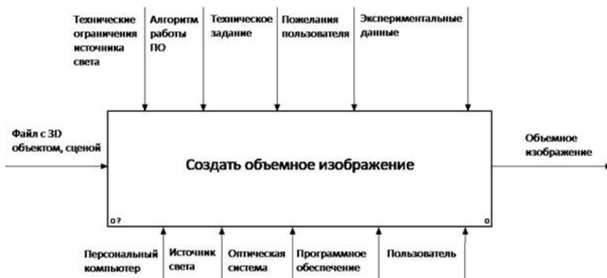
Рисунок 8 – Функциональное моделирование процесса создания объемного изображения (0 уровень)
