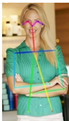
Рисунок 3 – Пример результата работы нейросети Fast Pose Estimator с выделенными частями тела человека
