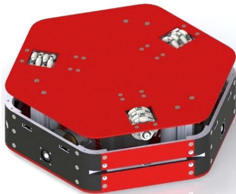
Рисунок 9 – 3D-модель транспортного робота для проведения типовых транспортировочных операций [12]
