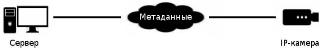
Рисунок 3 – Схема анализа видеопотока на камере
