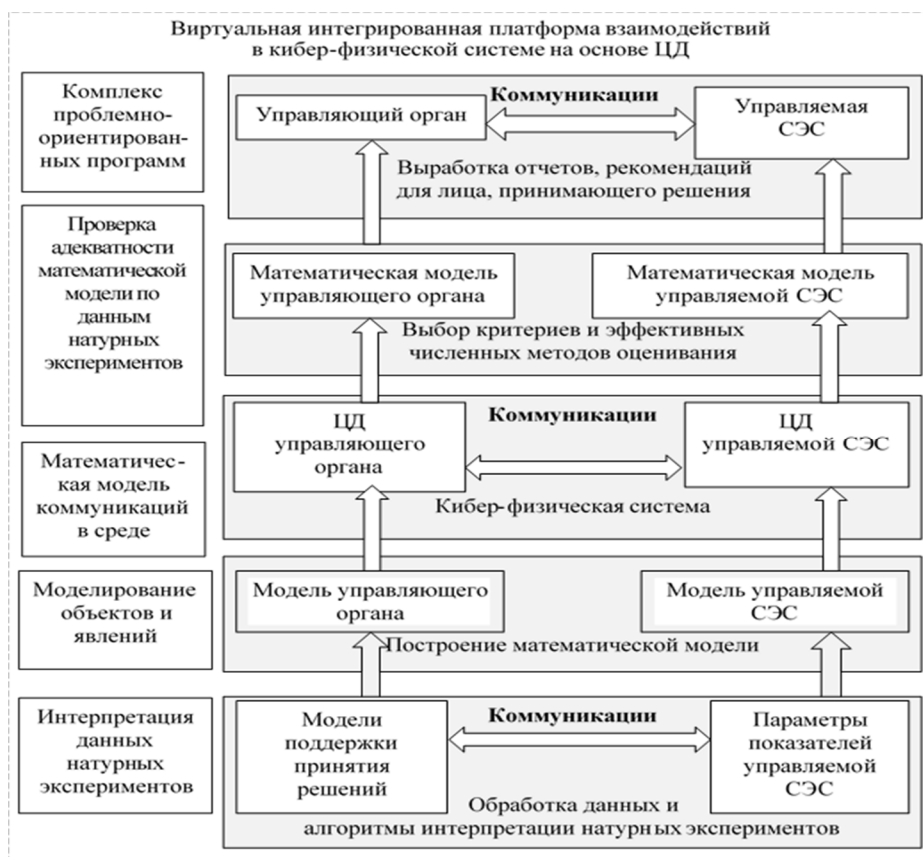
Рисунок 1 – Архитектура интегрированной платформы кибер-физических системы с использованием математического моделирования для применения результативных математических методов на основе статусных функций
