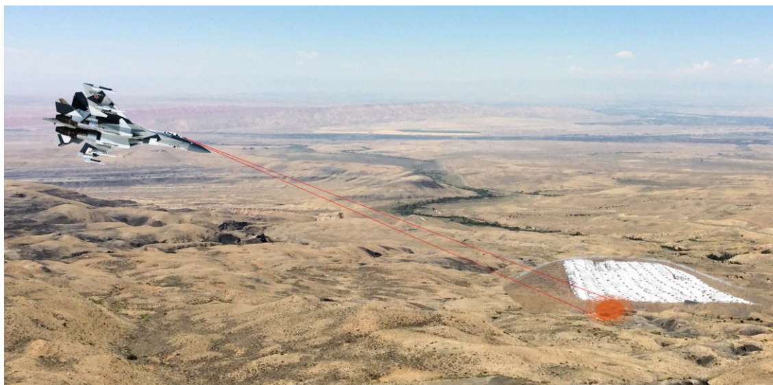
Рисунок 1 – «Засветка» фотоприемников периферийными областями лазерного пятна
