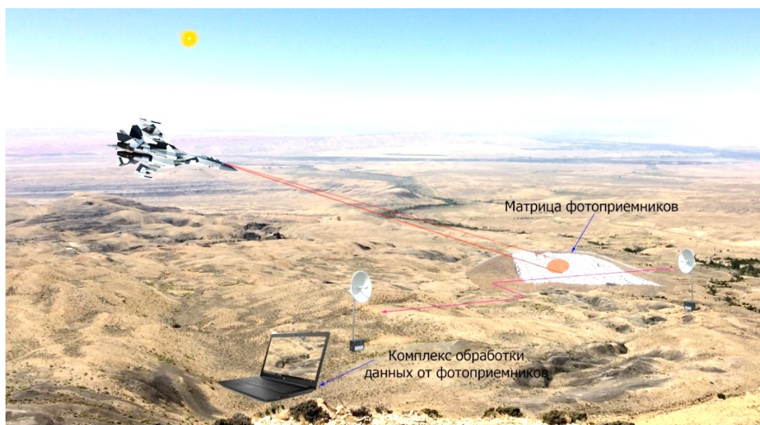
Рисунок 5 – Схема эксперимента при статическом способе выбора чувствительности фотоприемников
