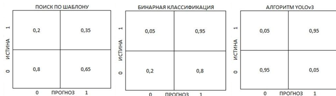
Рисунок 7 – Матрицы ошибок для тестового набора для алгоритмов поиска по шаблону, бинарной классификации сверточной нейронной сети, YOLOv3
