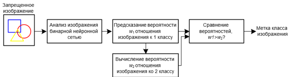
Рисунок 2 – Структурная схема работы бинарной классификации при помощи сверточной нейронной сети
