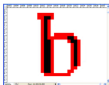
Изображение трассированное с помощью алгоритма МППГ (не обнаружены пиксели внутреннего угла) Image traced using the MPPG algorithm (no inner corner pixels detected)
