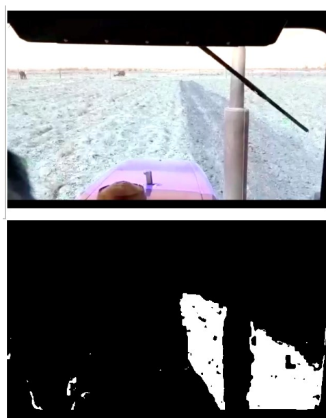
Рисунок 1 – Определение границ областей вспашки при помощи детектора границ Кэнни
